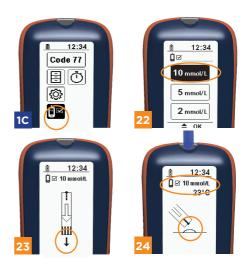
Jetez la première goutte de solution de contrôle. Déposez la deuxième goutte de solution de contrôle sur une surface non absorbante (par ex. : un film de plastique ou une feuille d'aluminium) et déplacez l'appareil de mesure avec la bandelette réactive insérée dans celui-ci jusqu'à la gouttelette. Laissez la gouttelette remplir la chambre de mesure. Un signal sonore retentit lorsque la chambre de mesure est suffisamment remplie.
