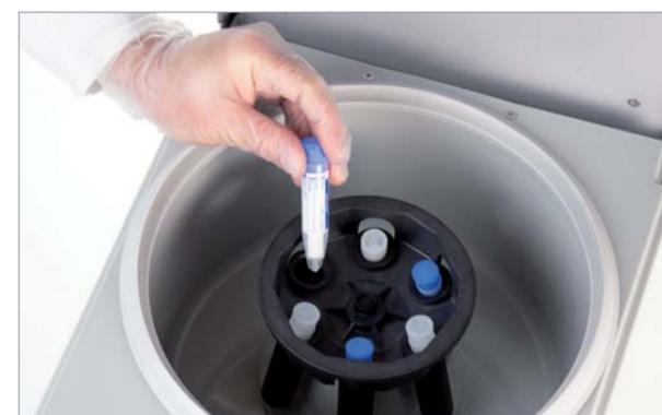
Centrifugation des salivettes pour les prélèvements de salive.
