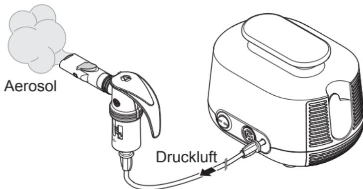
Der Kompressor versorgt den Vernebler mit Druckluft.
