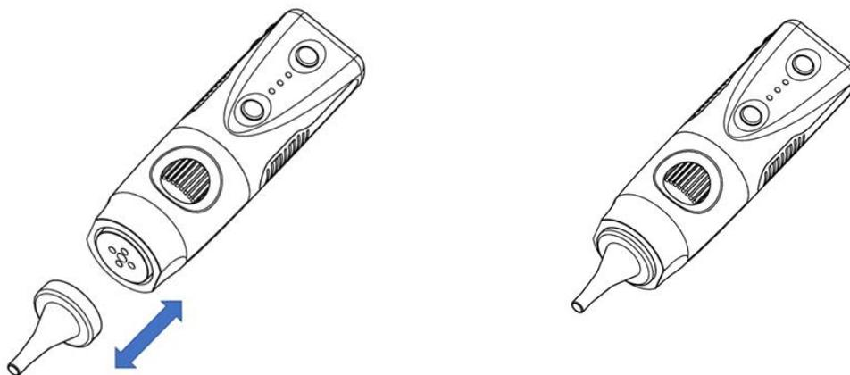
Enfoncez le spéculum dans la rainure circulaire à l'avant de l'otoscope. Pour retirer le spéculum, tirez simplement dessus.
